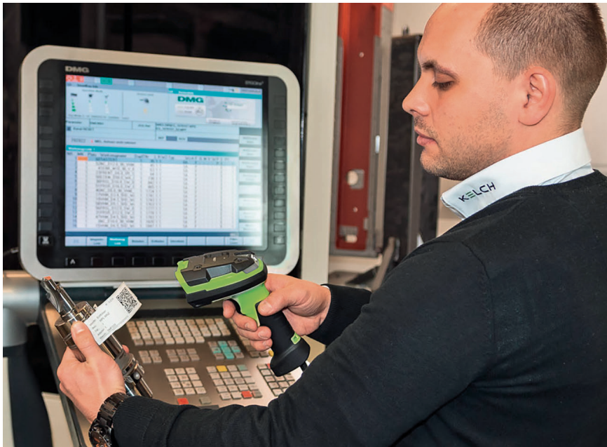
2 Lückenlose und aktuelle Bestandsdaten, die vor- und nachgelagerte Arbeitsschritte betreffen, sind mit dem Werkzeugverwaltungstool garantiert © Kelch
